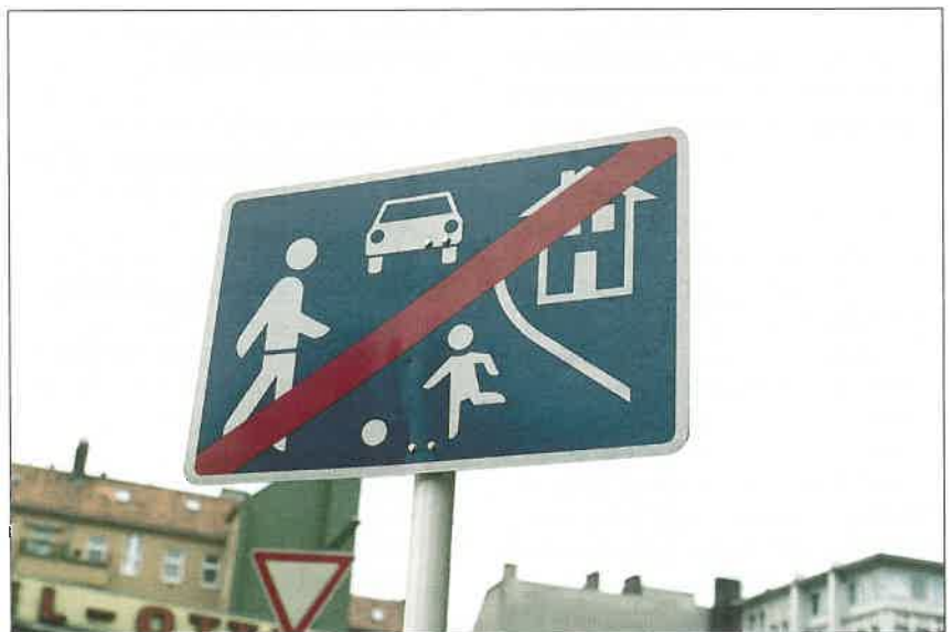
Señal de salida de área residencial con coexistencia de tráfico en Alemania.
