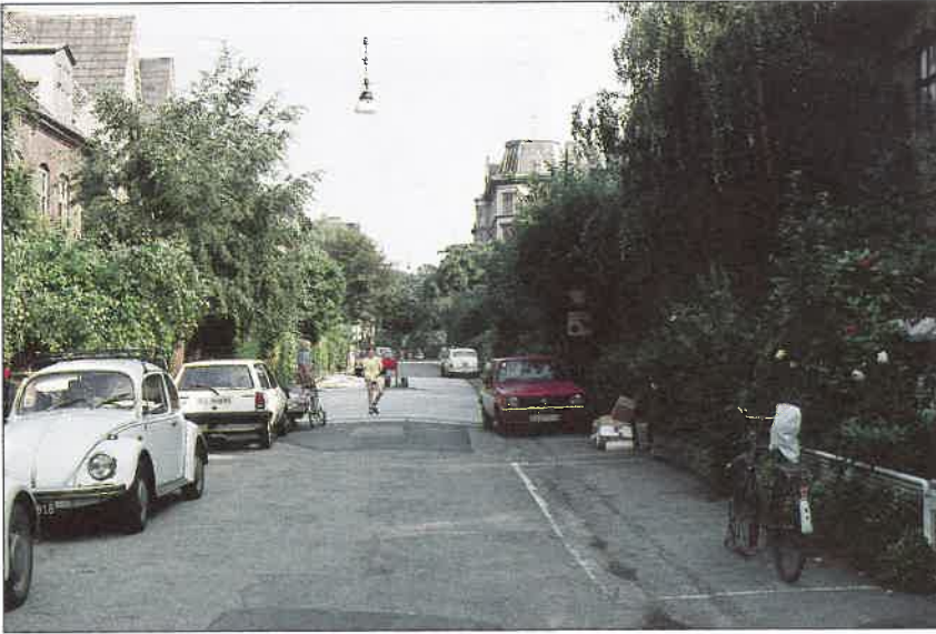
Calle residencial de coexistencia de tráficos en Copenhague. Velocidad limitada a 15 km/h y área central de juegos.
