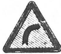
4 CURVA PELIGROSA A LA DERECHA
