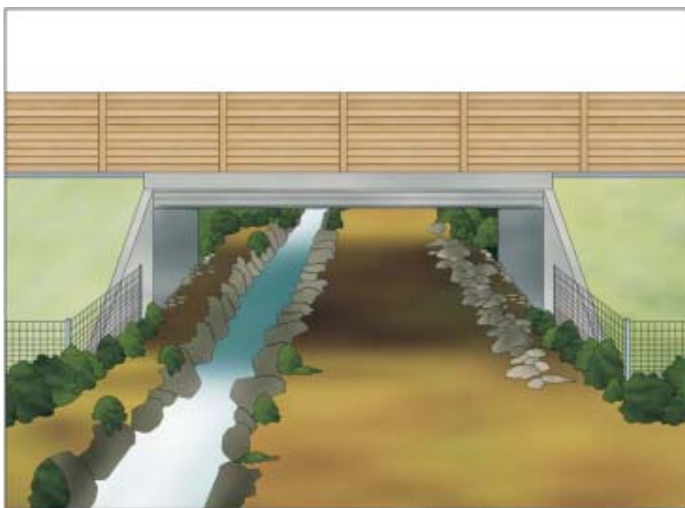
Figura 7.6 – Disposición de una acequia en uno de los márgenes de la estructura, dejando amplias franjas destinadas al paso de fauna.
