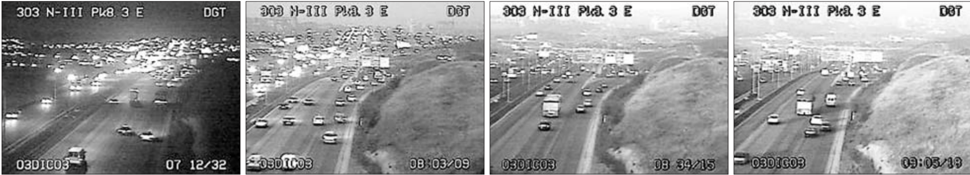
KILÓMETRO 8.3. Las incorporaciones de los vehículos procedentes del barrio de Santa Eugenia (27.700 habitantes) se dejan notar todavía en este punto kilométrico. Los peores momentos se viven a las 8.00 horas, con un tránsito de 4.320 vehículos diarios. A partir de ahí el flujo de automóviles desciende en picado hasta los 1.860 movimientos que se registran a las 9.00.
