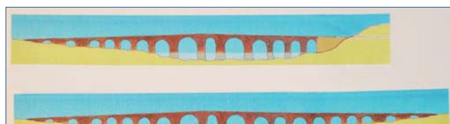
Figura 7. Perfil de un puente situado en terreno llano comparado con el perfil -arriba- del puente Mantible
